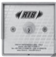
Commande pour tout type d'automatisation. Équipé de deux micro-interrupteurs avec contact N.O. de 15A 250V (Ouverture / Fermeture) et d'un interrupteur avec contact N.F. de 4A 250V (Stop).
